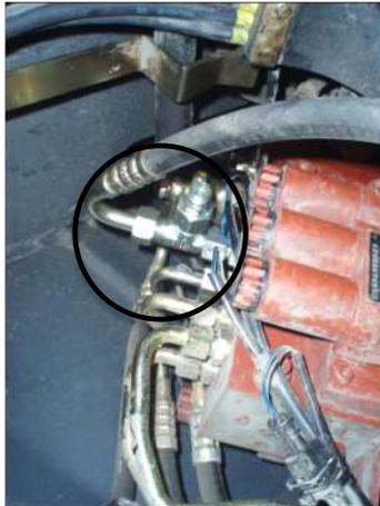
*T montada en el Tubo de presión del de la Válvula de control principal del mástil para elevación/descenso de las horquillas.
